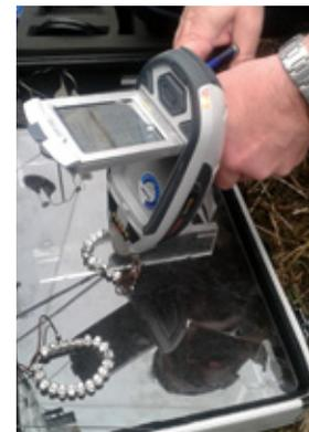
Messung eines Armbandes im Strahlenschutzkoffer mit dem mobilen RFA-Gerät.
