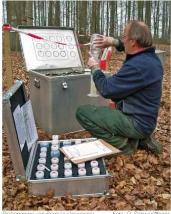
Probenahme von Bodensickerwasser
