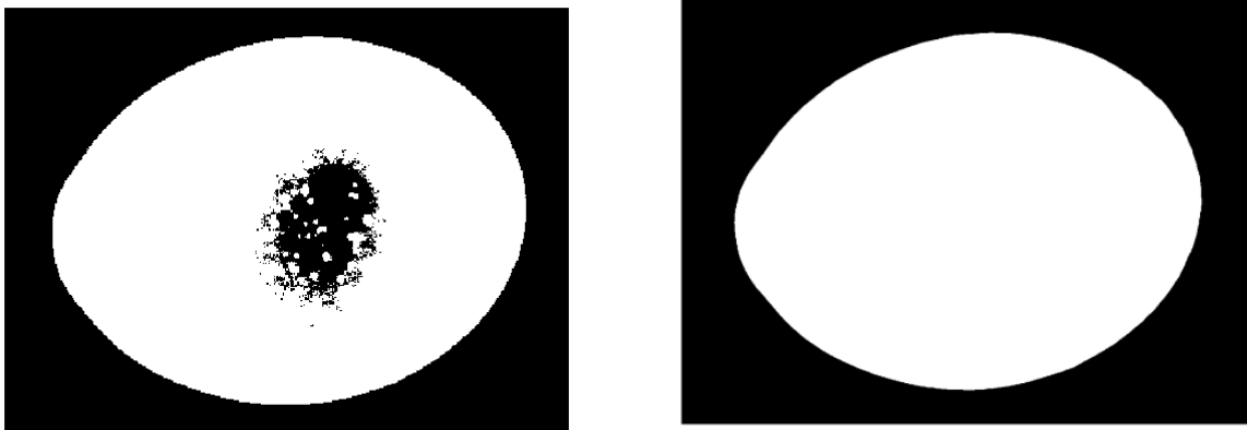
Abbildung 12: links: Rotkanal nach der Schwellwertsegmentierung mit dem Schwellwert S; rechts: Ergebnisbild aus Schritt 1 (ROI) - Rotkanal nach der Schwellwertsegmentierung und morphologischer Operation zum Schließen der Löcher im Objekt
