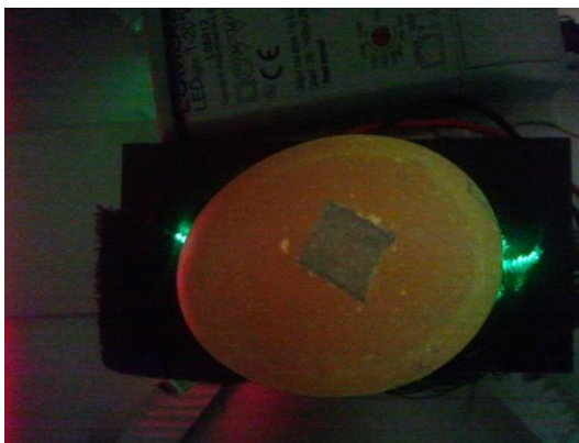
Abbildung 7: Diese Abbildung zeigt ein mittels Laserstrahlung entfärbtes braunes Ei. Es kann sehr gut erkannt werden, dass durch diese Art des Entfärbens keine verbesserte Detektion der Keimscheibe durch die Kalkschale hindurch möglich ist.
