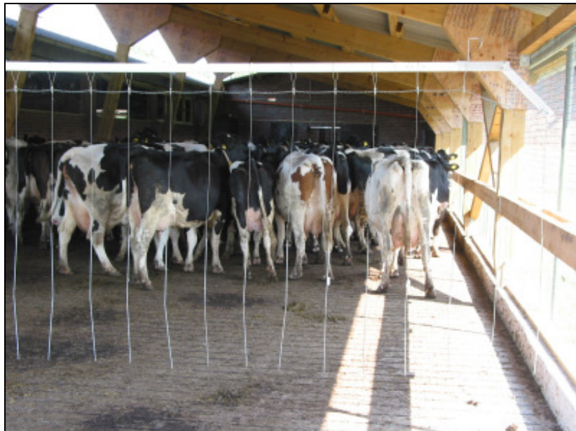
Abb. 26: Automatische Treibhilfe im Vorwartehof (Foto: Petermann)
