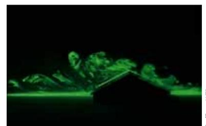
Visualisierung der Luftströmung mit Laserschnitt
