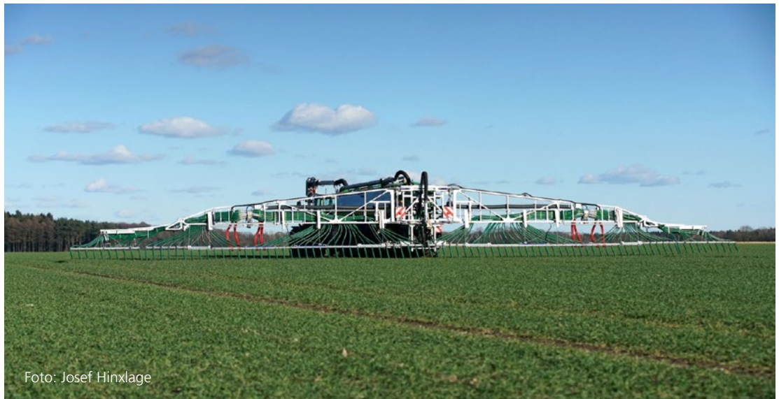
Emissionsarme Gärrestdüngung mit Schleppschlauch
