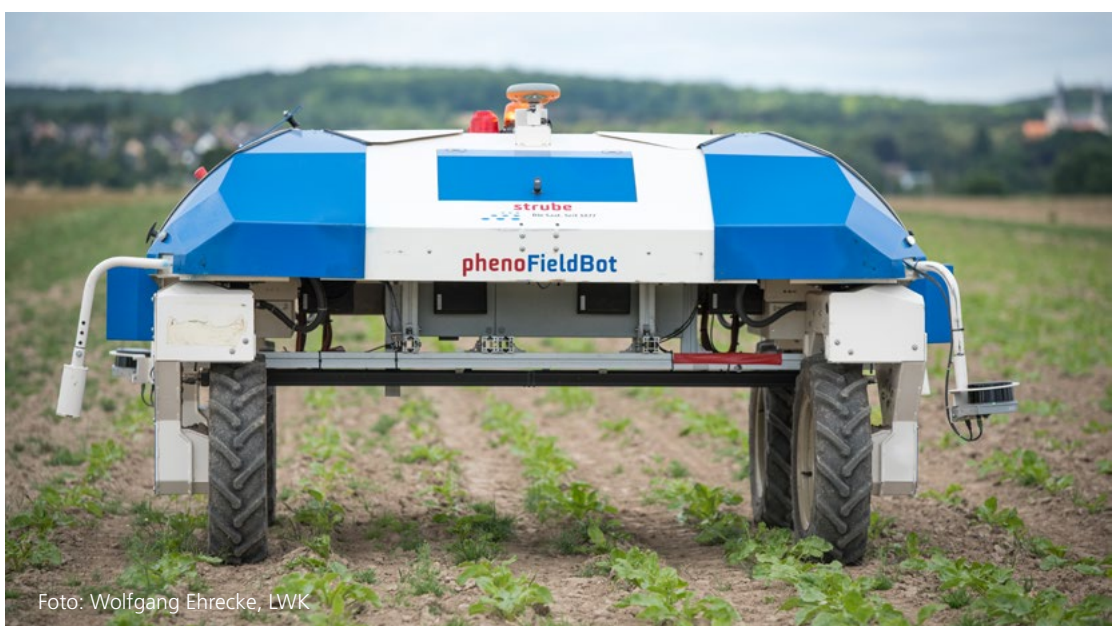
Autonomer Feldroboter bei der Erfassung der phänologischen Entwicklung eines Zuckerrübenbestands
