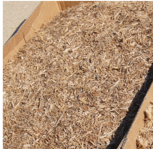
Einblasdämmstoff aus breitblättrigem Rohrkolben im Landkreis Oldenburg (Foto: 3N Kompetenzzentrum)
