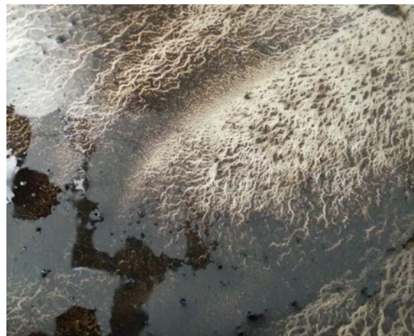
Abbildung 4: Prozesswasser in Metall-Laborschale; feine Partikel setzen sich ab (Ausschnitt etwa 100 mm breit)
