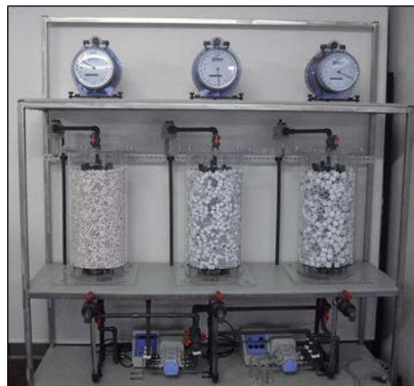
Abbildung 3: Versuchsstand mit drei Fermentern mit Festbettschüttung vor Inbetriebnahme und ohne Isolierung; für dieses Projekt wurden bereits bewachsene Füllkörper verwendet
