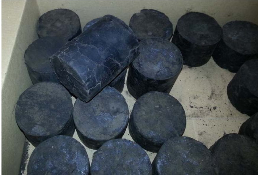
Abbildung 7 Briketts aus der HTC-Kohle aus der Carbonisierung von separiertem Gärrest (etwa 60 mm Durchmesser)
