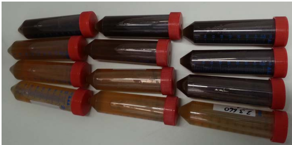
Abbildung 6: Veränderung des Gärrests aus den drei Festbettreaktoren; nach sukzessiver Umstellung von künstlichem Substrat auf Prozesswasser (links/ Mitte/ rechts: Fermenter 1 bis 3; von unten nach oben innerhalb von etwa 10 Tagen jeweils deutliche Zunahme der Trübung durch nicht abbaubare Bestandteile)
