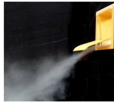
Luftleitung in den Tierbereich
